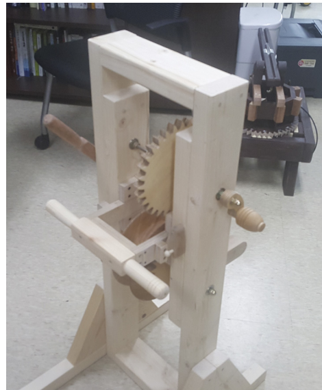
그림 5 클러치가 적용된 기계식 얼레 장치
