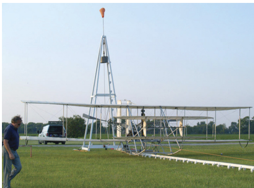
그림 2 라이트 형제가 개발한 중력 사출 시스템
